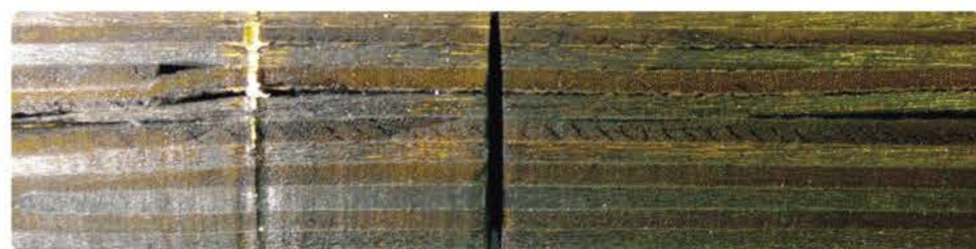
Comparación de la ranura de suajes de CNC máquina de corte a sierra y láser
