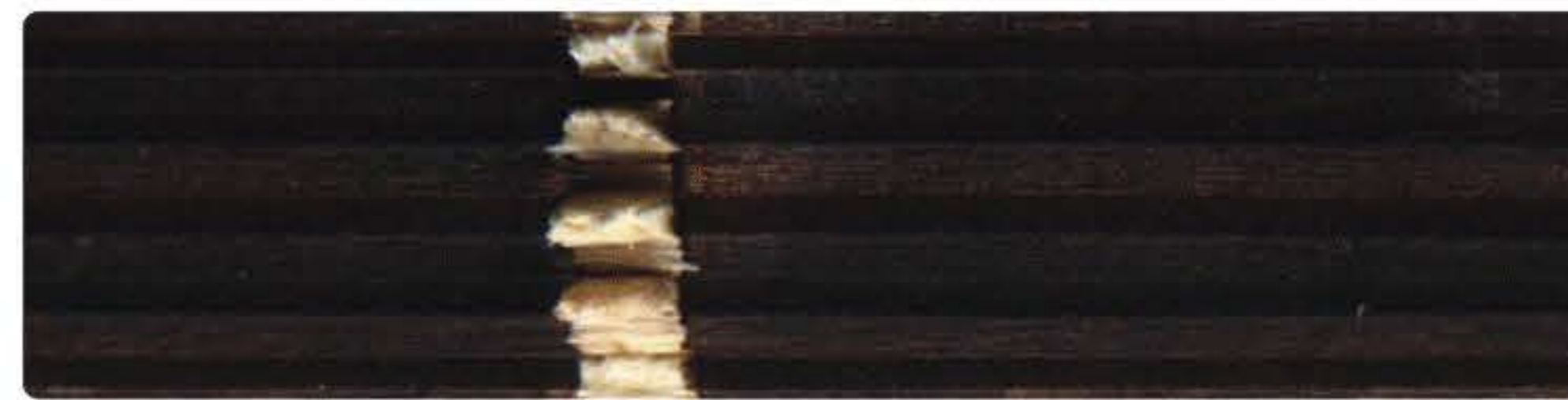
Comparación del superficie de ranura de suajes de CNC máquina de corte a sierra y láser
